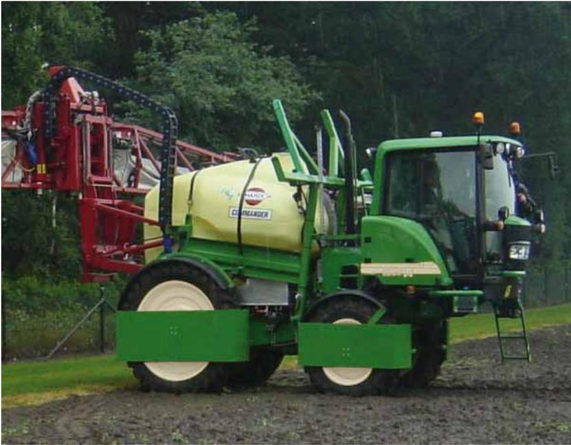
Dort, wo sich ursprünglich die Radkästen befanden, wurde neuer Stauraum geschaffen. Um weitere Arbeitsgeräte mitführen zu können, kann unter der Kabine ein großes Gestell befestigt werden. Alle Hähne befinden sich in direkter Reichweite. Auch der Tank ist über eine Leiter und eine Plattform leicht zugänglich. Neben der ergonomisch angebrachten Füll- und Spüleinrichtung wurde auch ein Händewaschtank nicht vergessen. Der Motor ist mit nur wenigen Handgriffen leicht zu erreichen
