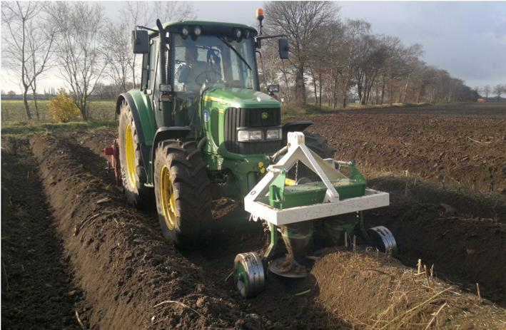
Der Spargo Compact ist bestimmt für das abscheiden der unterirdischer Laub, wobei in einem Durchgang das Laub oberflächlich im Schab ablegt wird. Durch die genaue Tiefenregelung schneidet die Maschine das Laub ab ohne der Krone zu beschädigen. Dies schafft einem homogenen Spargeldamm. Die Maschine kann sowohl vorne als hinten dem Traktor montiert werden.
